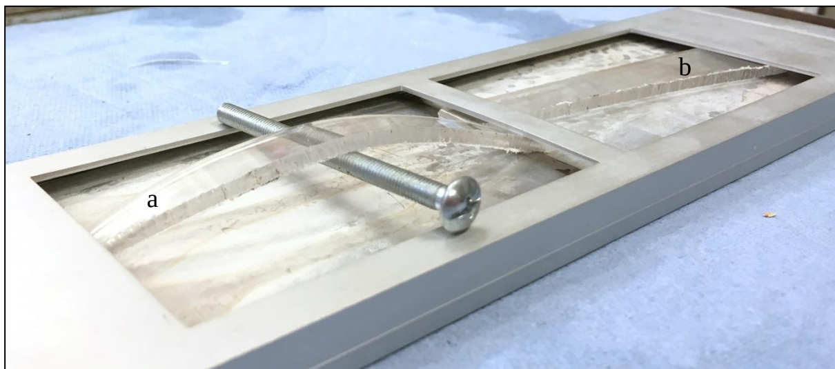
Figur 13. Fixturen med provbitar för UV-exponering. En bit i inspönt läge (a) och en bit i ospänt läge (b).
