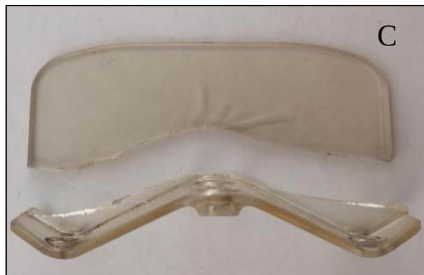
Figur 3. Visar snörasskydd som helt gått av. Bilden visar även tydliga sprickor i materialet.
