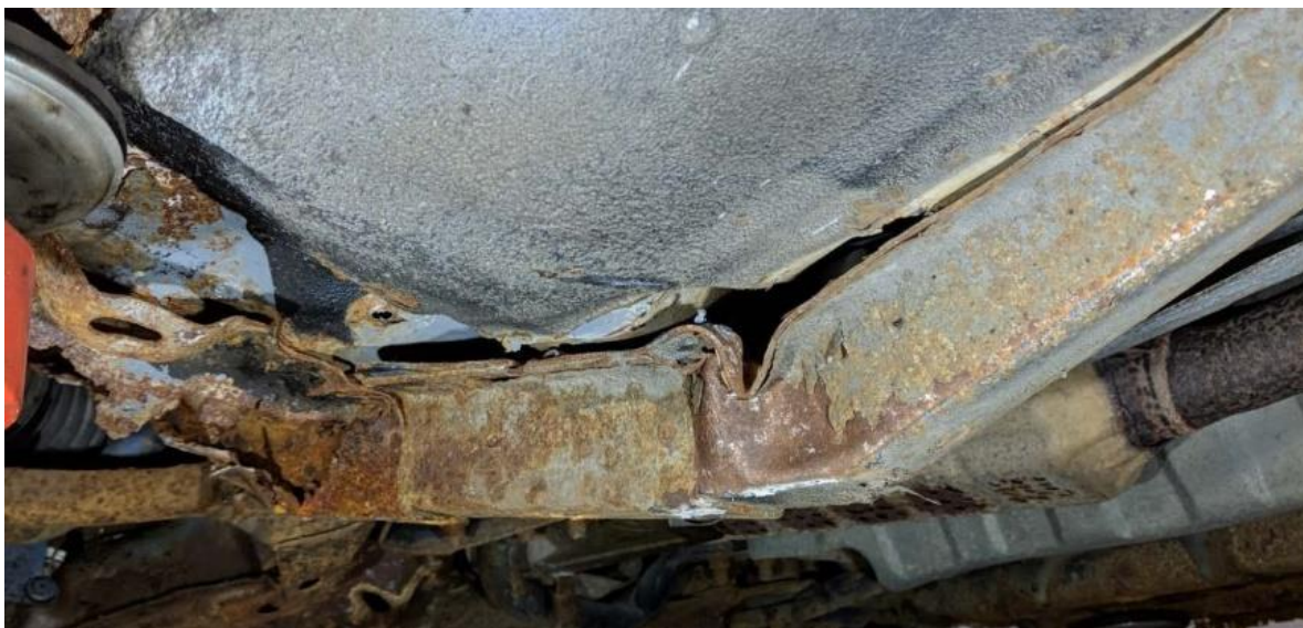
Figur 7 Förvridding av undre chassibalk
