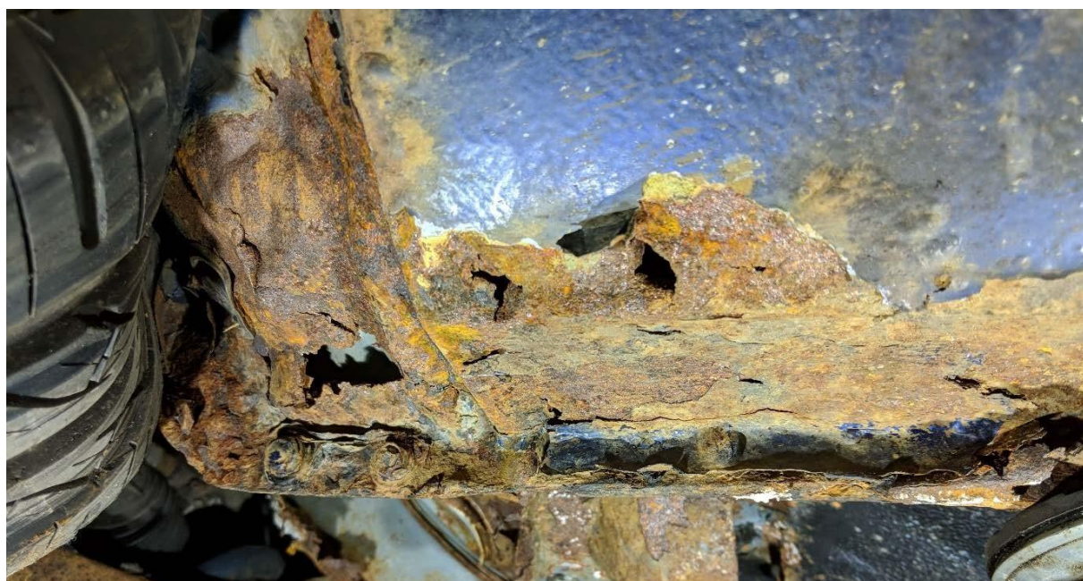
Figur 9 Tröskelstruktur bakom hjulet på förarsidan
