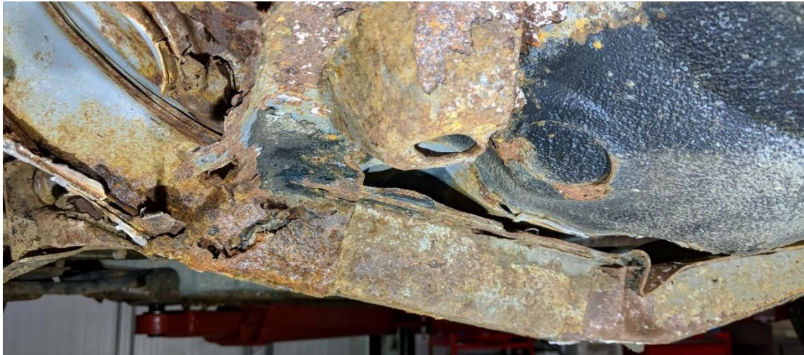
Figur 6 Chassibalken och golvet har släppt från varandra
