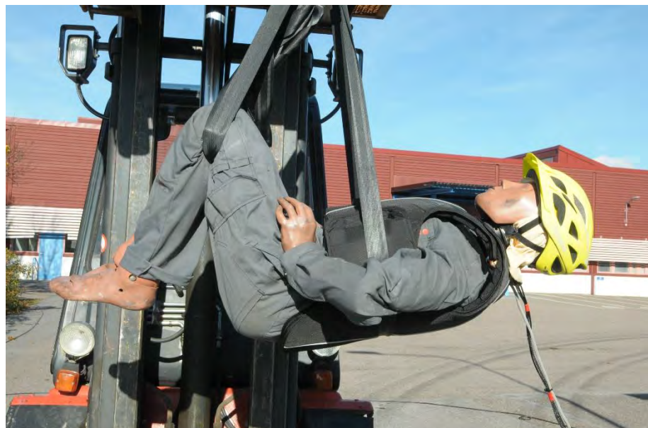
Krockdocka upphängd inför fallprov, med hjälm och ryttarväst.
