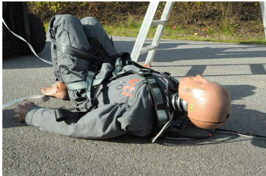
Krockdocka islag mot asfalt utan skyddsanordning.
