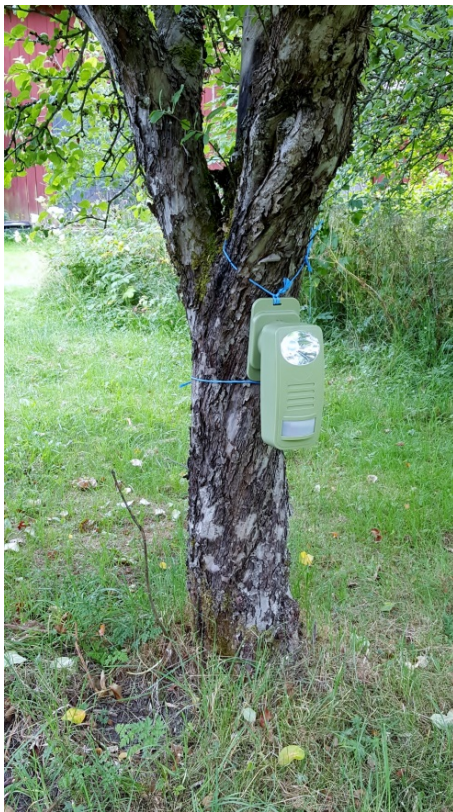
Figur 1. Skrämseapplikationen monterad ca 0,6 m från marken i ett äppelträd där avstånds- och funktionstesterna utfördes. Här monterad med snören – tillverkaren rekommenderar dock montering med medföljande skruvar. Foto: P. Kjellander, Sommarbacken, juli 2017.
