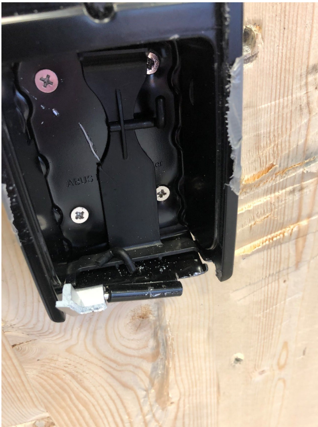
Bild 14 – ABUS 787 C efter angrepp mot gångjärnssida på lucka
