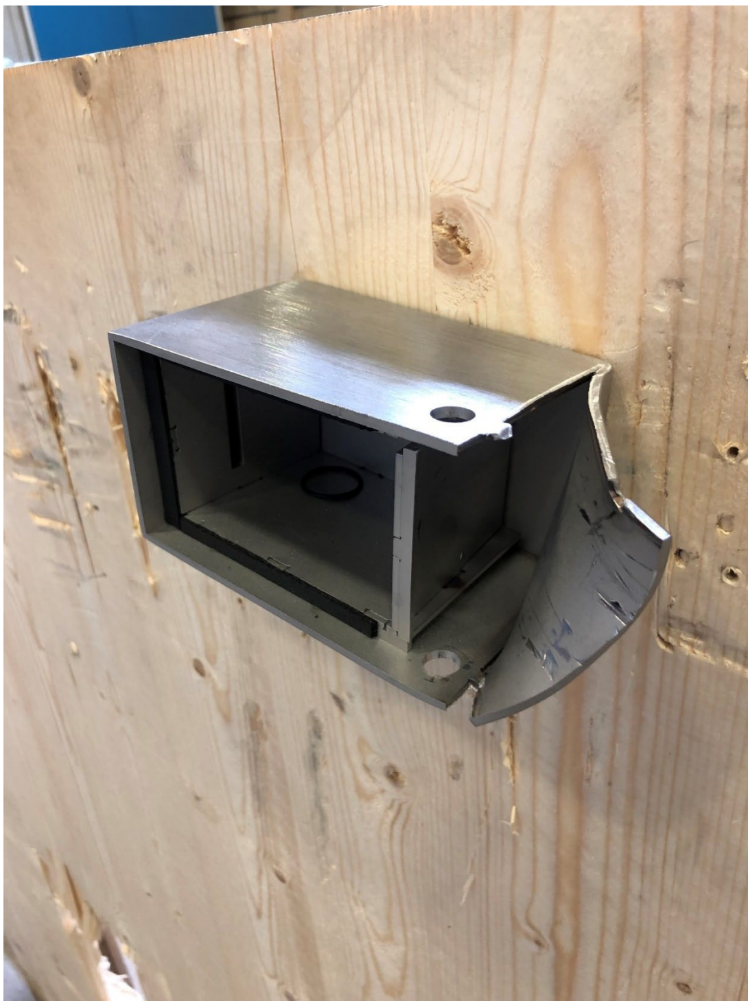
Bild 13 – Masunt 520 M efter angrepp mot gångjärnssida på lucka
