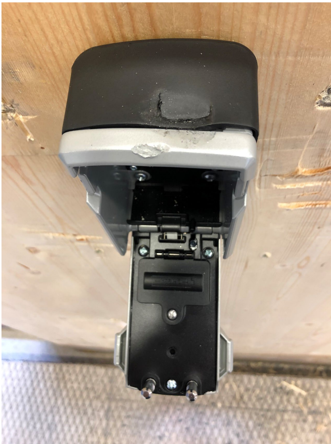
Bild 15 – Master Lock 5441 efter angrepp med hammare
