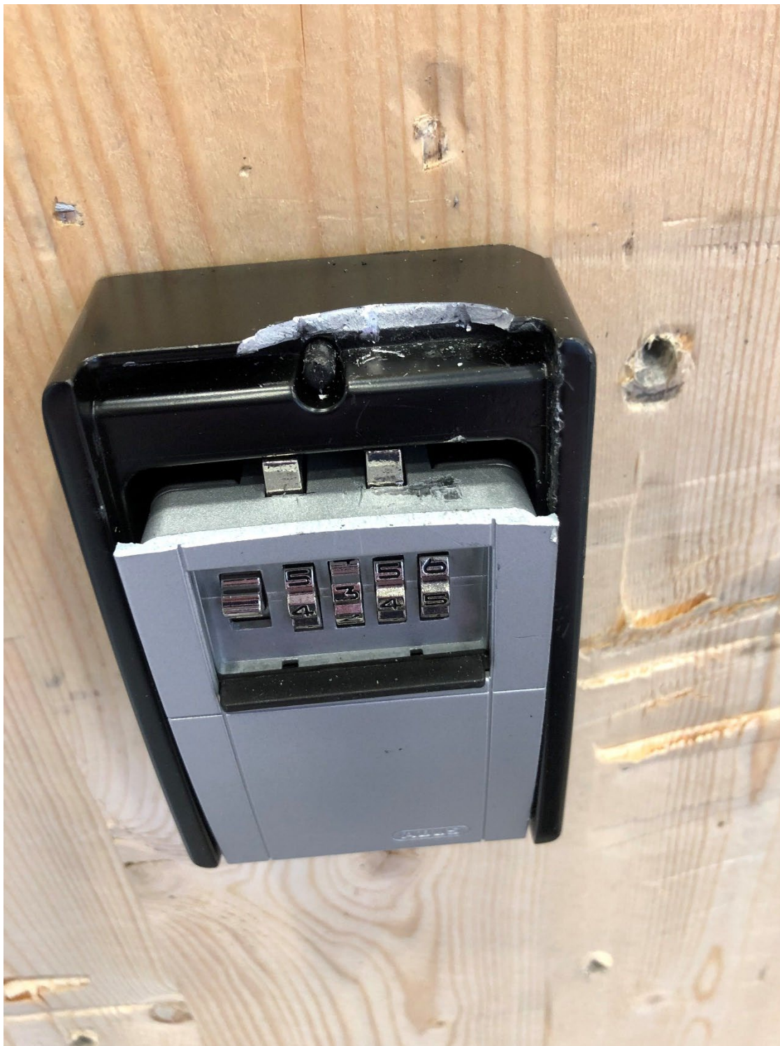
Bild 10 – ABUS 787 C efter angrepp mot låssida på lucka
