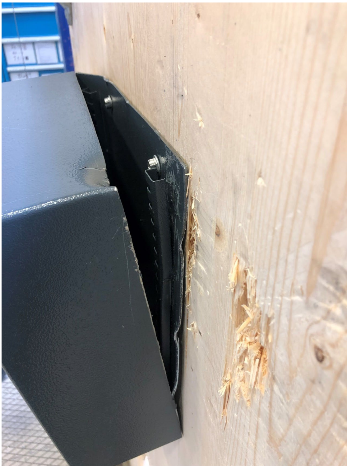
Bild 9 – HMF 2030-11 efter angrepp mot infästning
