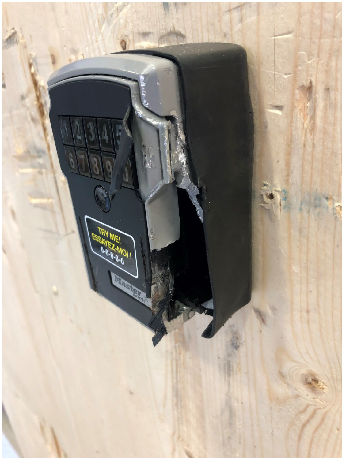
Bild 12 – Master Lock 5441 efter angrepp mot gångjärnssida på lucka
