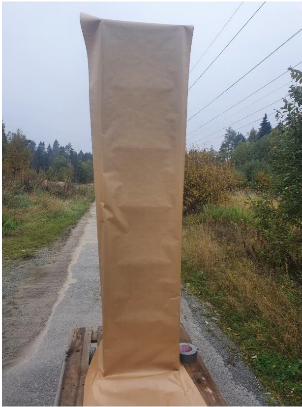
Figur 2. Kraftpapper monterat på stativet för detektion av stenskott.
