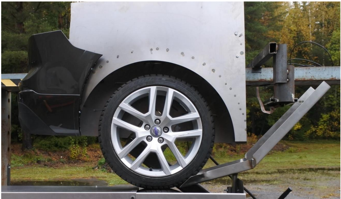
Figur 1. Provrigg för generering av stenskott. Här visad utan stänkskydd.
