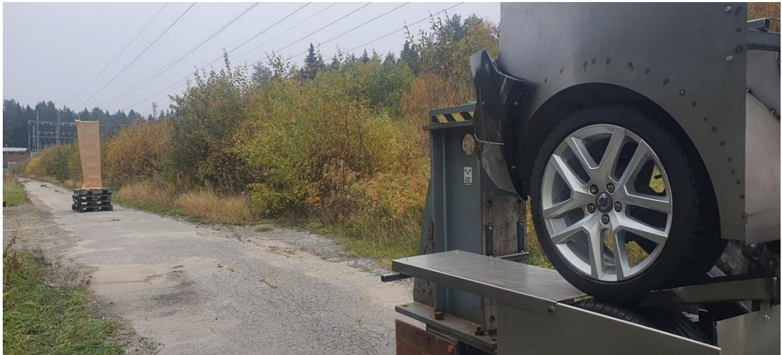
Figur 4. Provuppställning med stativet placerat 17 m ifrån hjulens kontaktpunkt.
